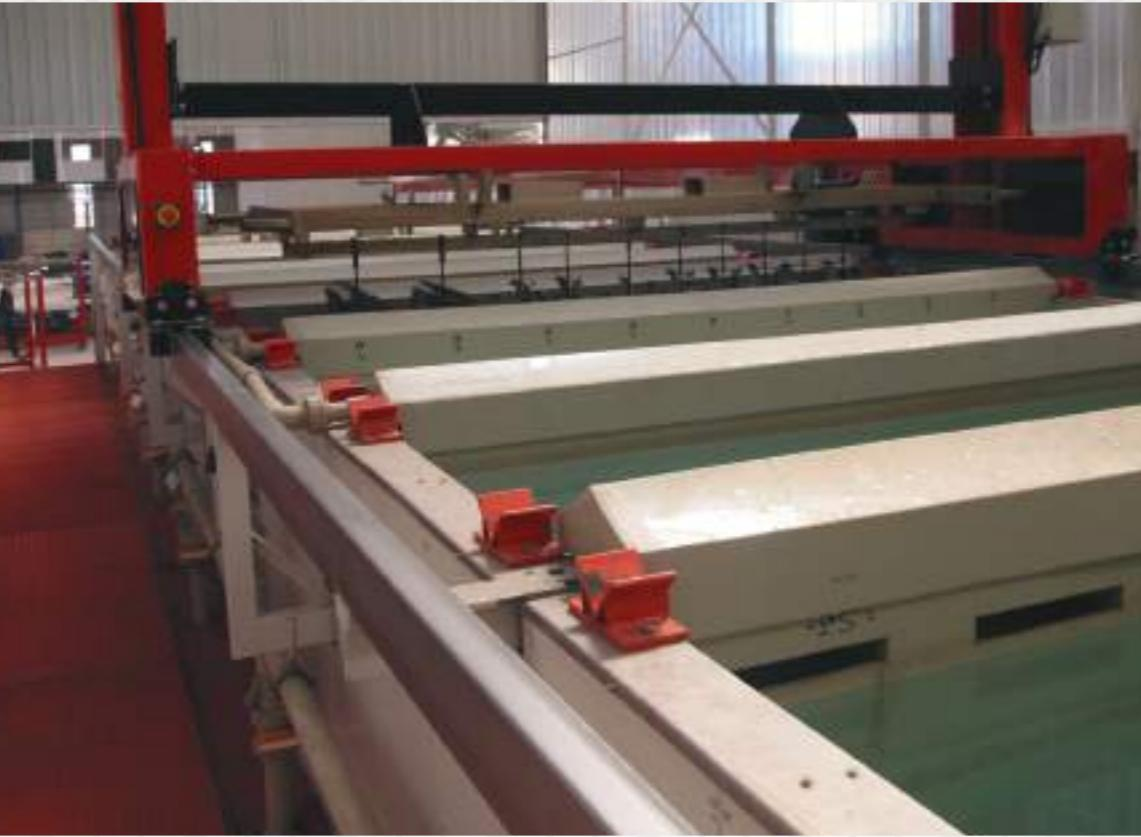
Установки для катофорезного покрытия поверхности, в которых используется процесс электропокрытия, опирающийся на основные электрохимические принципы, проектируются и выполняются согласно размеров материала.
