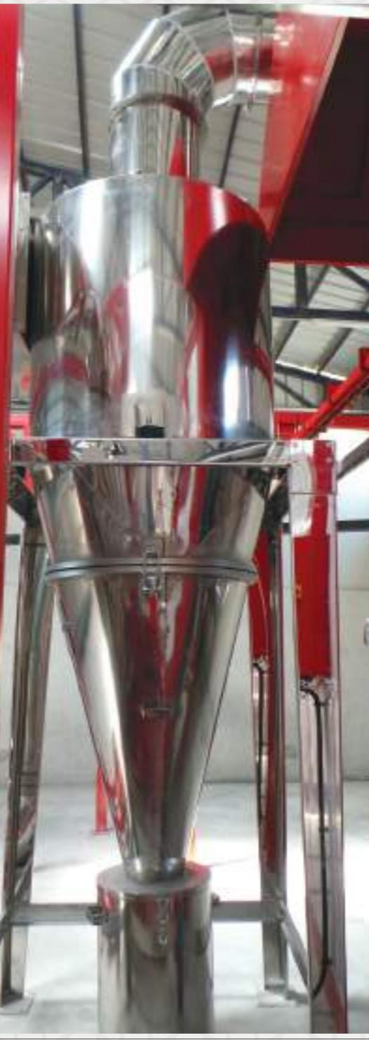
Циклоны, производимые на нашем предприятии, являются сепараторами, которые используют центробежную силу для очистки воздуха, содержащего частицы краски, поглощенные из камер порошковой покраски.
