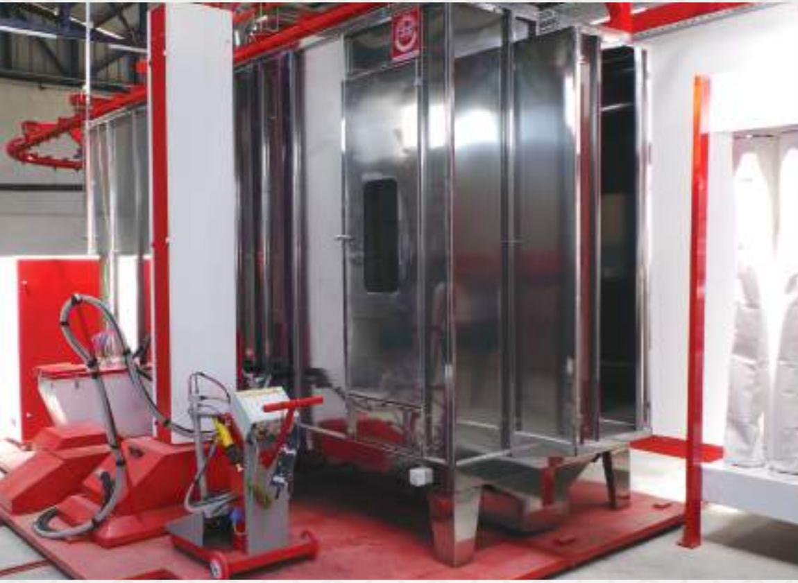
Камеры для порошковой покраски, которые производятся на нашем предприятии, представлены в следующих вариантах: с фильтром, компактным циклоном, моноциклоном и мультициклоном.
