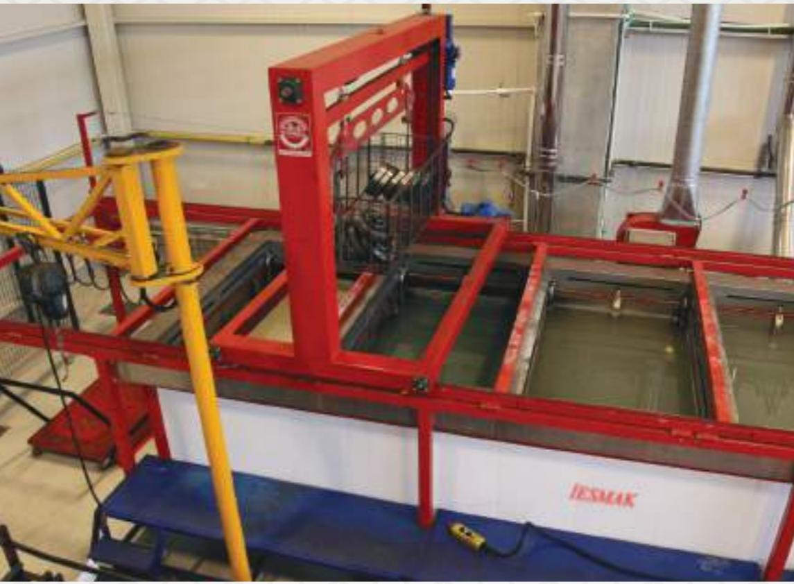
Котлы очистки поверхности по методу погружения и печи для сушки по методу погружения, которые производятся на нашем предприятии, проектируются и изготавливаются согласно размеров материала и процесса очистки. Котлы изготавливаются из нержавеющего материала AISI 304 и 309. Котлы свариваются нержавеющей сваркой, чтобы обеспечить высокую стойкость к химикатам.
