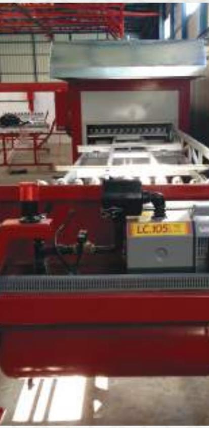
МАШИНЫ ДЛЯ ПЕРЕНОСА ПОКРЫТИЯ, ИМИТИРУЮЩЕГО ДЕРЕВО
