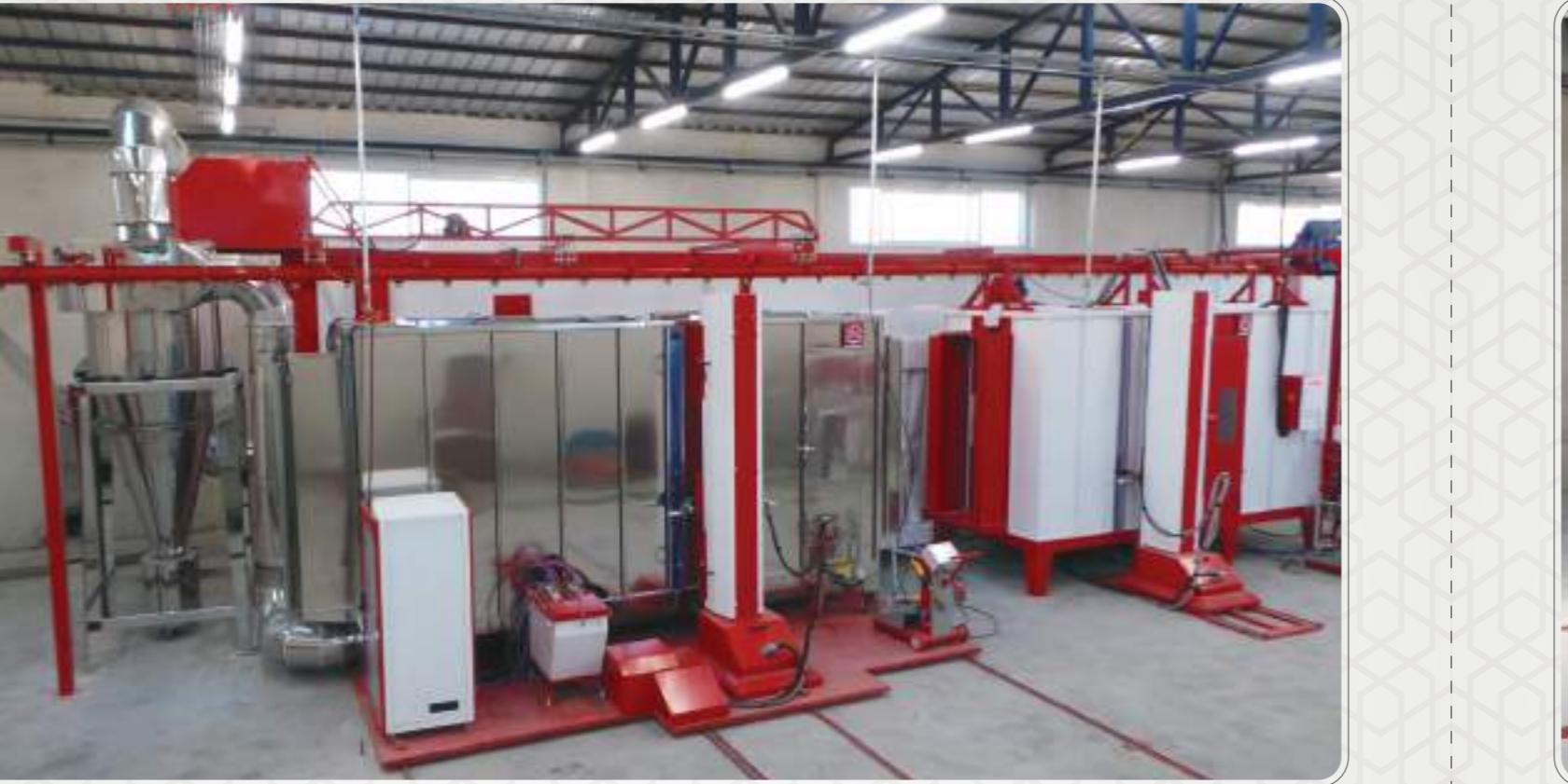
Firmamızda üretimi yapılan toz boyama kabinleri; Filtreli, Kompakt Siklonlu, Mono Siklonlu ve Multi Siklonlu olarak tasarlanmaktadır.
