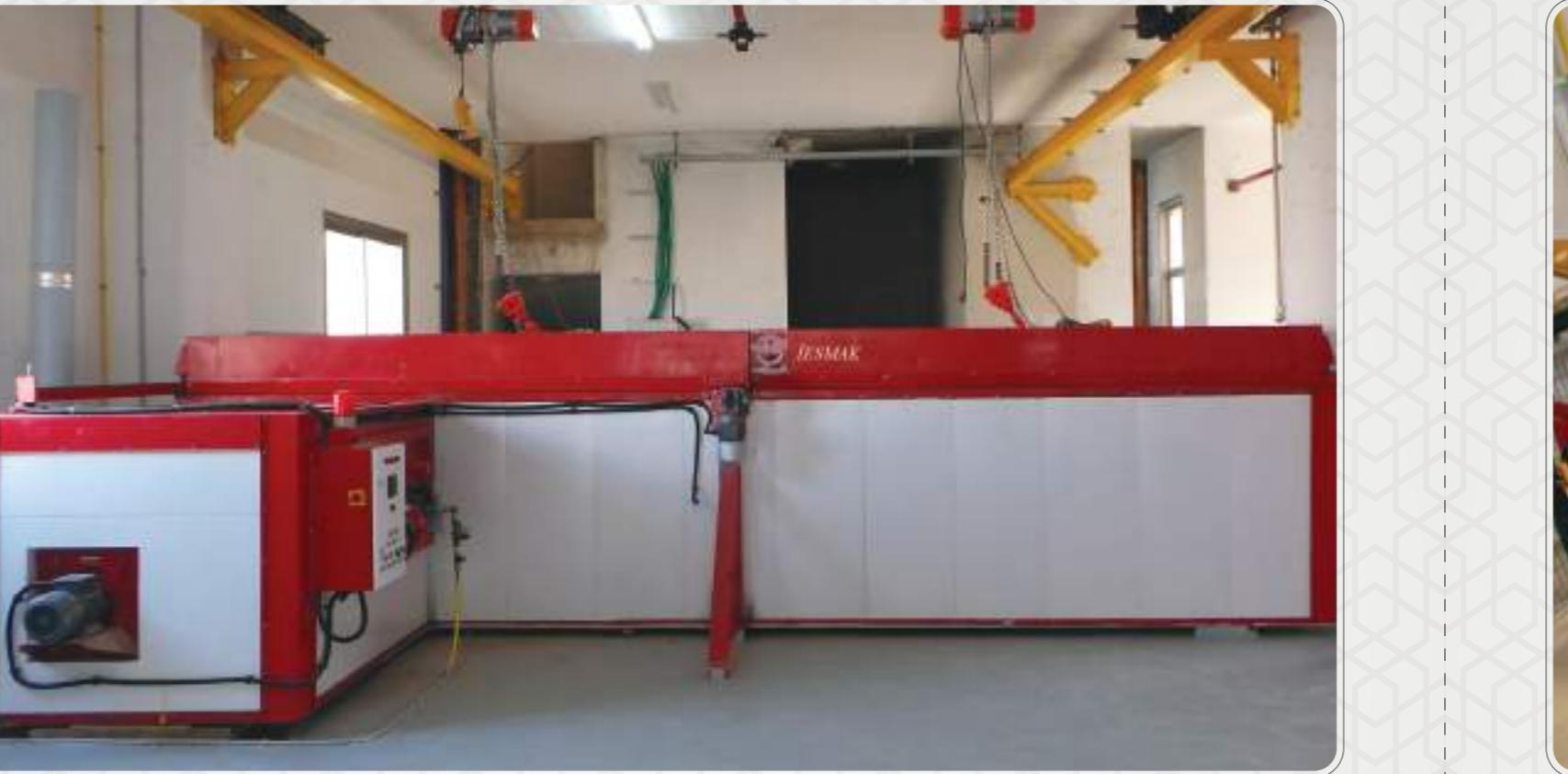
Firmamız bünyesinde üretilen daldırma tip yüzey temizlik kazanları ve daldırma tip kurutma fırınları, malzemenizin ölçülerine göre ve temizlik proseslerine göre dizayn edilerek imalatı yapılmaktadır. Kazanlarımız AISI 304 ve 309 Paslanmaz malzemeden imalatı yapılmaktadır.
