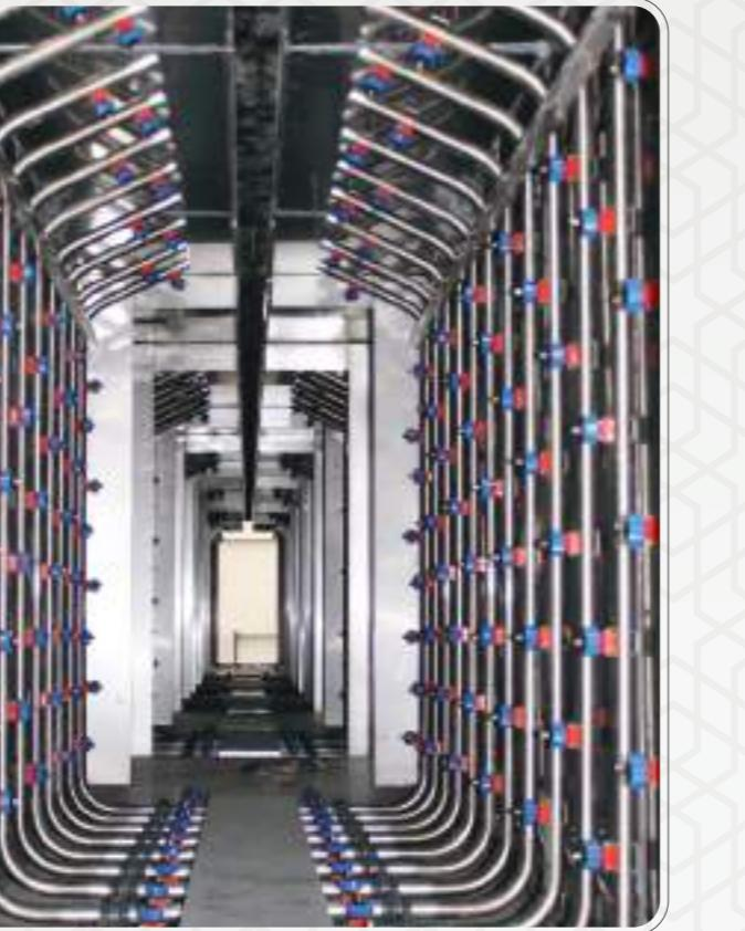
Установки для пульверизационной покраски и обмывки с конвейерной линией, которые производятся нашим предприятием, проектируются и производятся в соответствии с разными комбинациями процессов для фирм, которые занимаются серийным высокопроизводительным производством разных по размеру изделий, и обладают модульной конструкцией.
