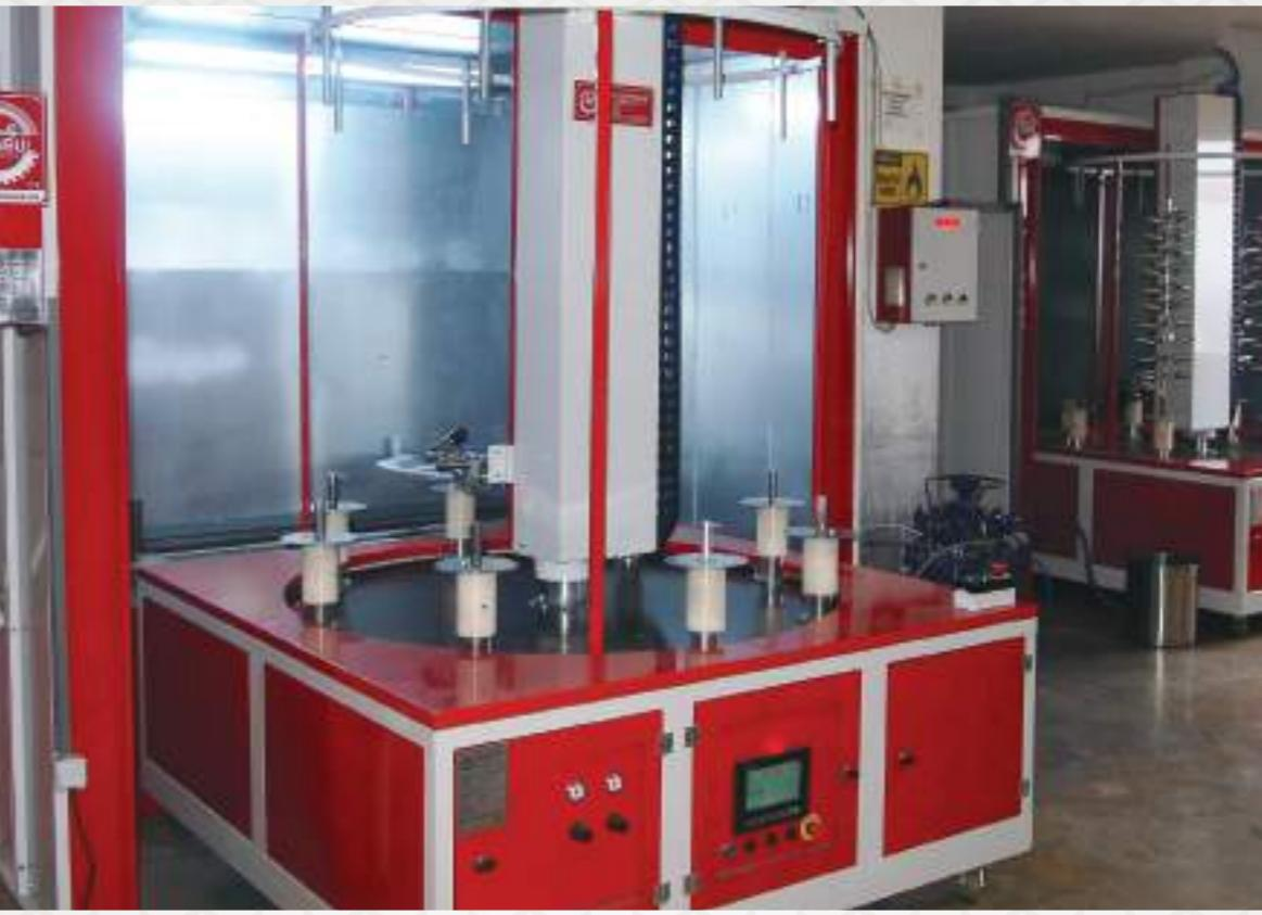
Камеры для покраски жидкотекущей краской, которые производятся на нашем предприятии, представлены в вариантах: система водной завесы, система с картриджным фильтром, камера положительного давления и система обработки погружением.
