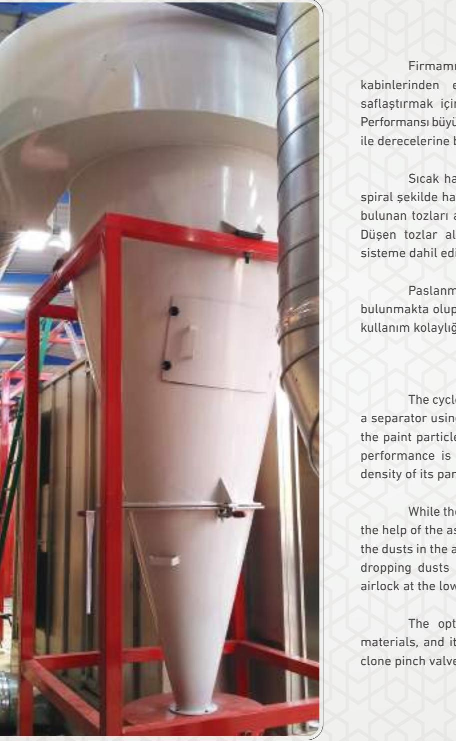
Firmamız bünyesinde üretilen siklonlar; toz boyalı kabinlerinden emilen boyalı partiküllerin yüklü havayı saflaştırmak için merkezkaç kuvveti kullanan bir ayırıcıdır. Performansı büyük ölçüde dönüş hızına ve partiküllerin yoğunluğu ile derecelerine bağlıdır.
